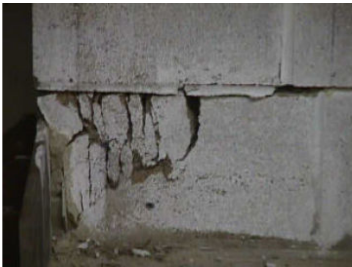
شکل پ - خرد شدگی نمونه غیر مسلح در ناحیه تحتانی (شکل بعد از خرابی)
