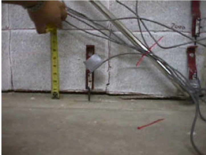
شکل ت - الیاف عمودی و نقش آن در افزایش مقاومت دیوار بنایی (شکل بعد از خرابی)
